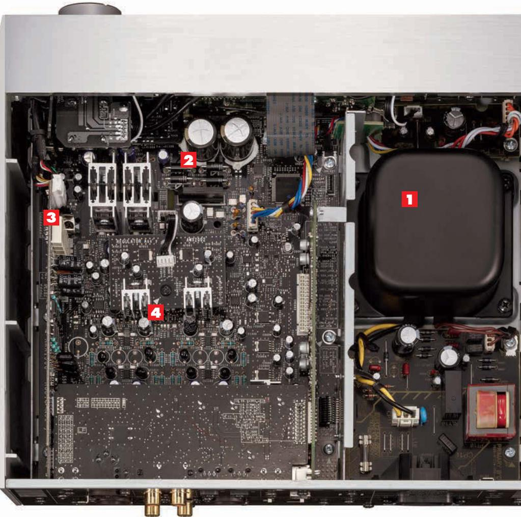
Innenansicht des Pioneer U-05: **1** Vibrationsgedämpftes, gekapseltes Netzteil, getrennt von signalverarbeitenden Baugruppen; **2** große Kondensatoren zur Speicherung der Energie; **3** High-Definition-D/A-Wandler mit PCM-, DXD- und DSD-Unterstützung; **4** passive Kühlkörper
