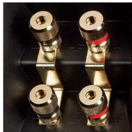
Bei **Bi-Amping**-Lautsprechern lassen sich Bass und Hochton über verschiedene Verstärker ansteuern. Verwendet man einen Amp, müssen die Terminals mit Brücken verbunden werden.
