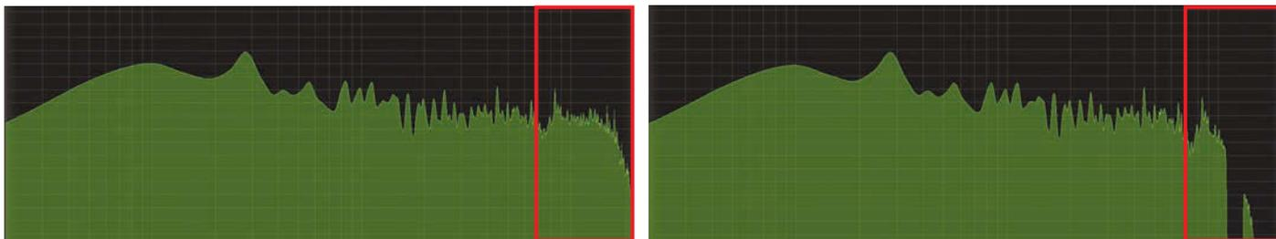
Die **Datenreduktion** von MP3 oder AAC filtert „unnötige“ Tonfrequenzen aus. Wie man im Frequenzspektrum erkennt, ist der Bereich oberhalb von 15 Kilohertz (**Rahmen**) bei einer 80-kbps-MP3-Datei (rechts) gegenüber dem Original (links) deutlich ausgedünnt.
