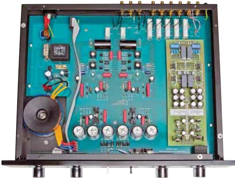
Ein makelloser Aufbau bestimmt das Bild in der diskret aufgebauten Vorstufe
