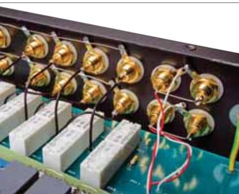
Relais schalten unmittelbar hinter den Buchsen die Eingangssignale um
