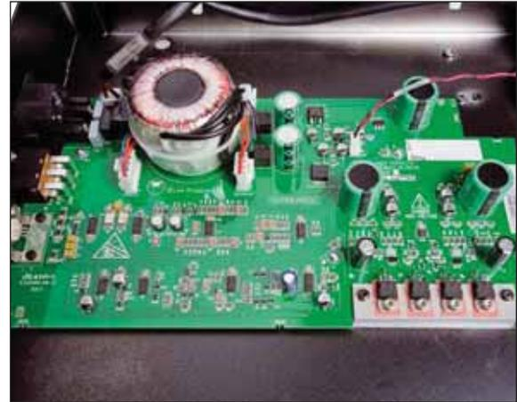
Im Inneren hat sich nichts geändert: Das Netzteil generiert eine eigene Wechselspannung zur Versorgung des Motors
