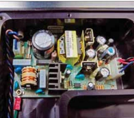
Das Schaltnetzteil der Capri S2 ist eine neue rauschärmere Variante
