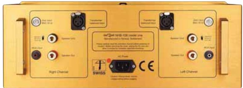
Auch die Endstufe verfügt über einen BNC-Eingang
