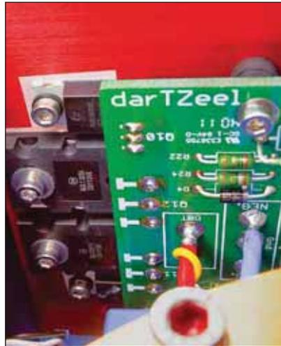
*Minimalistisch: Die Endstufe kommt mit einem Paar Endtransistoren pro Kanal aus*
