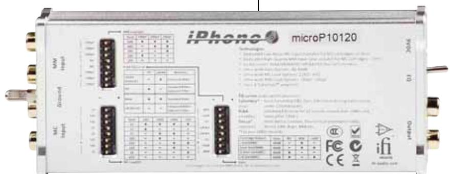
Nicht intuitiv bedienbar, aber extrem umfangreich sind die Einstellmöglichkeiten über Mäuseklaviere an der Unterseite
