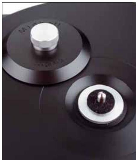
Die Filzscheibe hebt die Platte in der Mitte minimal an – die Klemme drückt sie dann über den Labelrand plan an den Teller
