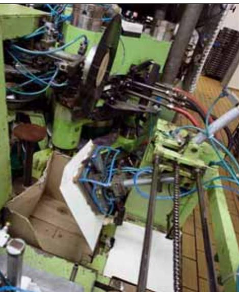
*Diese nachgerüstete Apparatur tütet die frisch gepressten Platten direkt zum Abkühlen ein*
