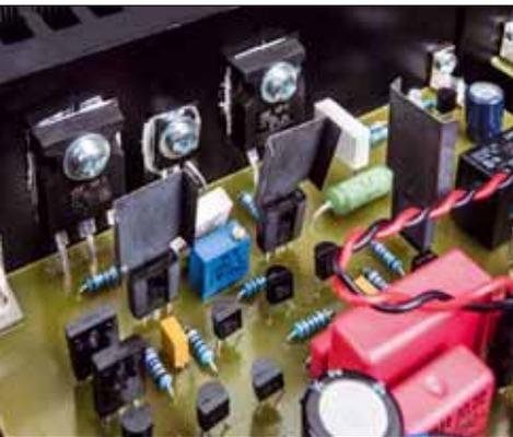
Zwei bipolare Endtransistor-klassiker besorgen die Ausgangsleistung der Endstufe
