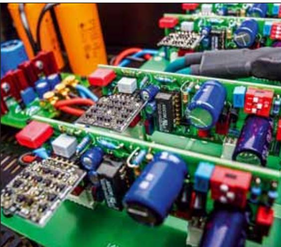
Die diskret aufgebauten Operationsverstärkermodule bilden das Herzstück der neuen Verstärkerschaltung
