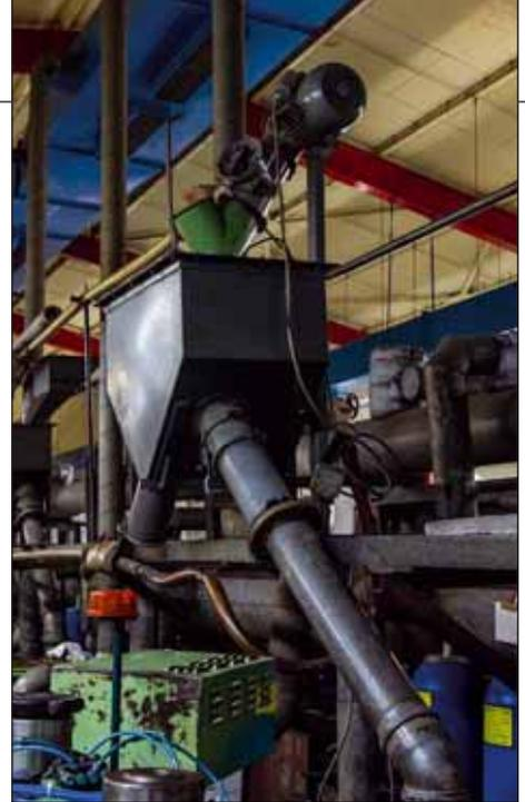
*Über dieses Rohrleitungssystem wird das PVC-Granulat per Druckluft zu den Maschinen befördert*
