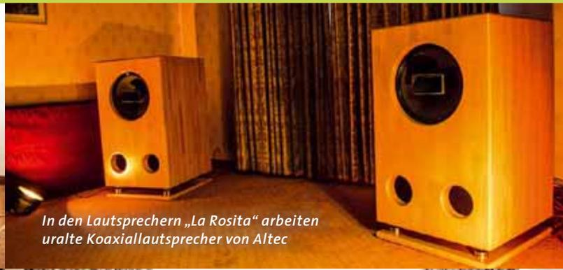
In den Lautsprechern „La Rosita“ arbeiten uralte Koaxiallautsprecher von Altec
