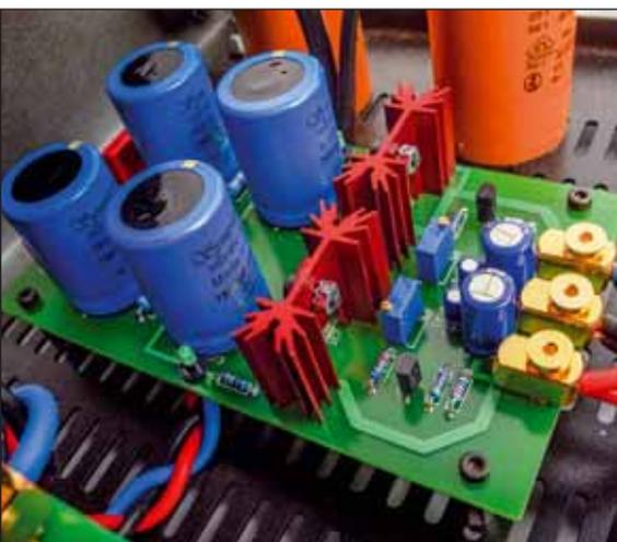
Die Reglerplatine stabilisiert die Betriebsspannungen für die Verstärkerschaltungen
