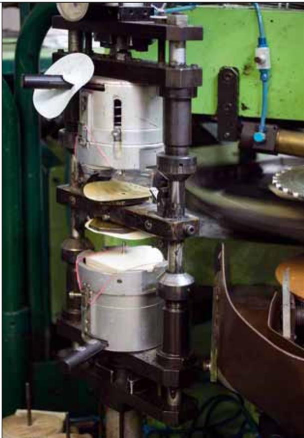
*Von diesem Stapel werden die vorgeheizten Plattenlabels geholt und mit verpresst*
