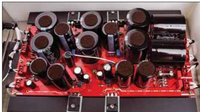
Die Netzteil-Sektion mit sorgfältig bedämpften Kondensatoren
