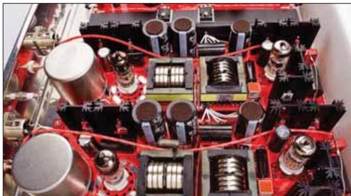
Die beiden streng getrennten Kanalzüge – gut zu erkennen sind die Kühlkörper der insgesamt zwölf Transistoren, die als Stromquellen der Röhren fungieren
