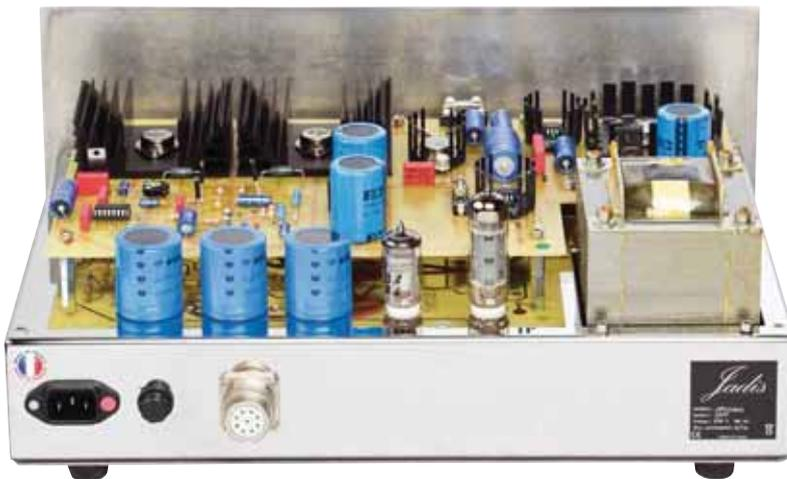
Die Versorgungseinheit geizt nicht mit Aufwand, sie generiert ihre eigene Wechselspannung zur Speisung des Netzteils
