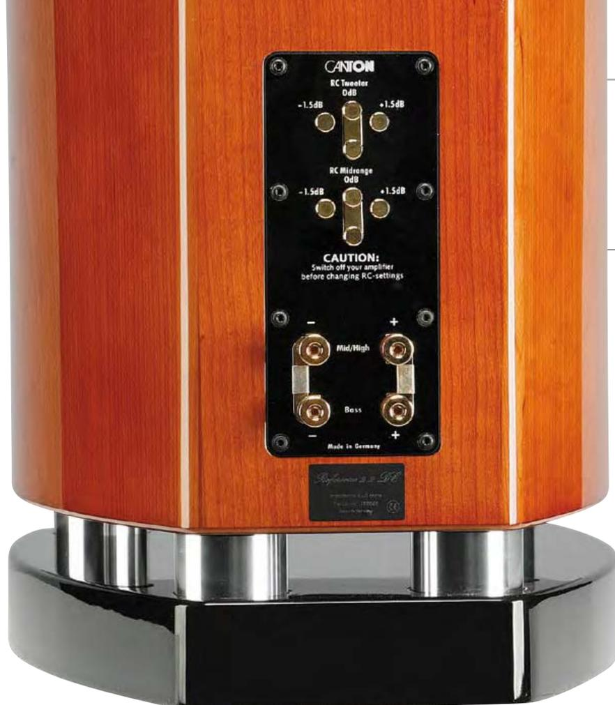
Pure Kontaktfreude: Hochwertige vergoldete Schraubklemmen fassen auch große Kabelquerschnitte. Der Frequenzverlauf lässt sich anpassen: Einfach die Brücken auf die entsprechend beschriftete Position stecken, schon werden Mittel- oder Hochton um 1,5 Dezibel angehoben oder abgesenkt.
