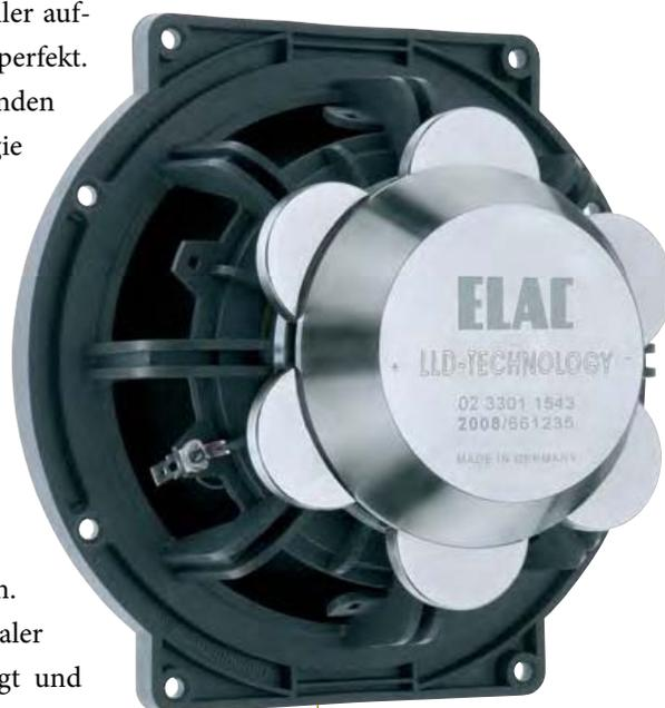
Der schöne Rücken eines innovativen Tieftöners: Die gut sichtbaren Neodym-Tabletten sorgen, in Eisen gebettet, für ein gleichmäßiges Magnetfeld. Dies ist die Voraussetzung für den extrem langen linearen Membranhub von 16 Millimetern. Der Korb ist strömungsgünstig und gleichzeitig sehr stabil geformt
