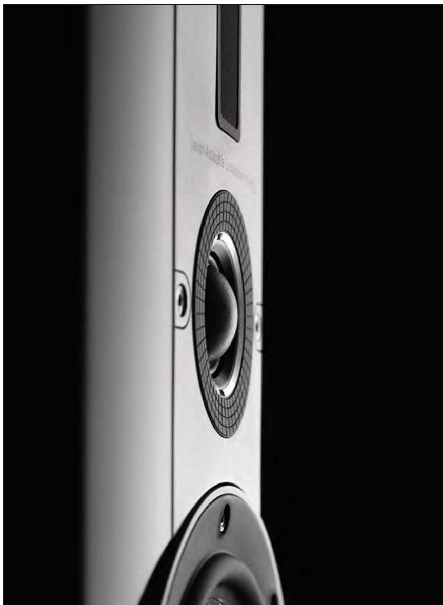
Die 29 Millimeter große, aber dennoch federleichte Gewebekalotte ist äußerst belastbar. Ein besonders dünnflüssiges magnetisches Fluid im Luftspalt kühlt den Antrieb
