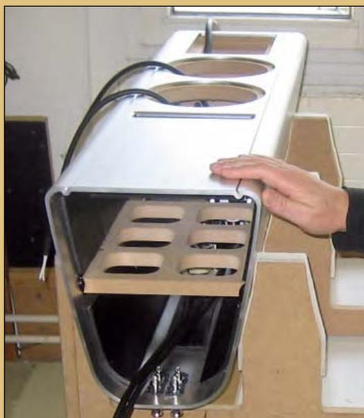
Das Gehäuse wird mit Holzfaserverplatten versteift, die Schallwand, der Boden und der Deckel daraufgesetzt
