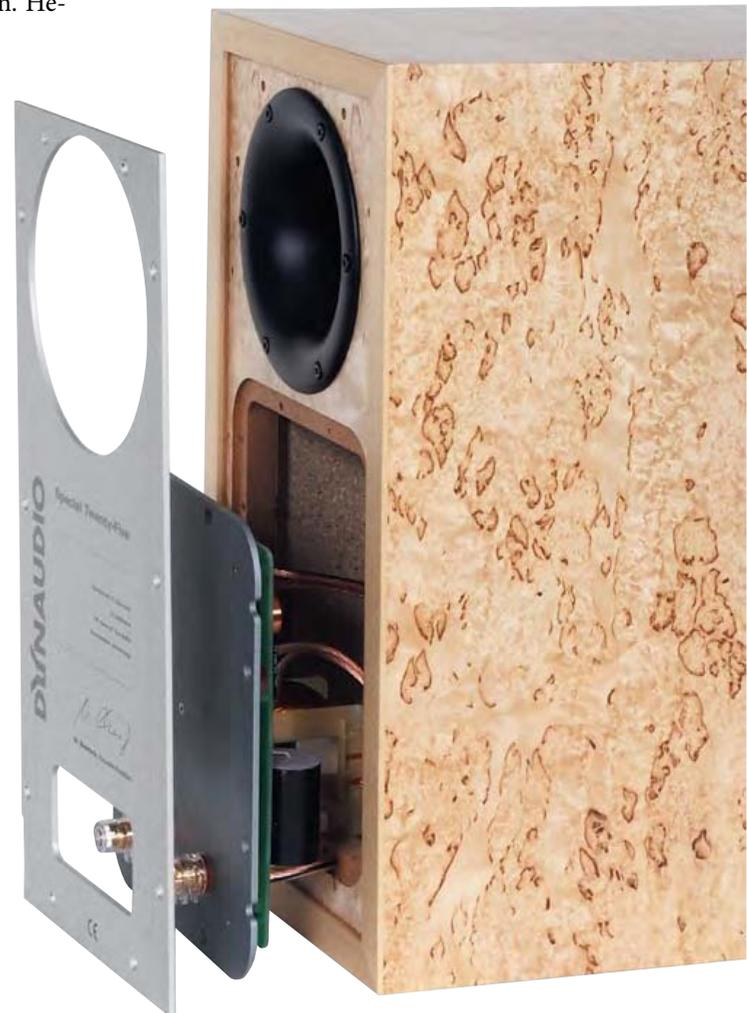
timer-Chassis liefert den Tiefton. Die Dänen fügen seine Membran aus Magnesium-Silikat-Polymer zusammen. Den Antrieb übernehmen eine leichte, aber 7,5 Zentimeter breite Aluminium-Schwingspule und ein kräftiger Neodym-Magnet. Der strömungsoptimierte Korb des Basschassis besteht ebenfalls aus Aluminium. Sein vorderer Rand sitzt auf der Schallwand, ist also nicht bündig in die Front eingelassen. Nur so schafften es die Dänen, die „Special Twenty-Five“ mit geringsten Serienabweichungen zu fertigen.
