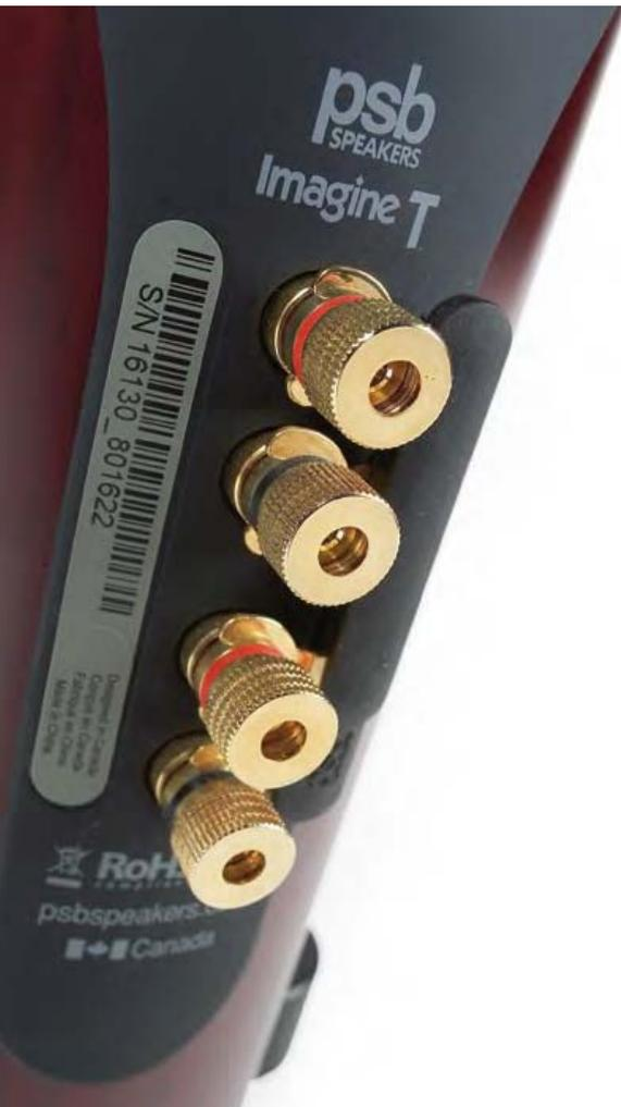
Das massive Anschlussterminal liegt direkt unter den Bassreflexöffnungen. Seine Klemmen fassen sowohl Bananenstecker als auch Kabelschuhe
