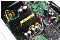
Zwei kleine Hochfrequenztransformatoren (Mitte) mit gegenüber liegenden Ringkernen geringeren magnetischen Streufluss sitzen zwischen schirmenden Kühlkörpern im Netzteil.
