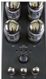
Schraubenzieher benutzer: Unter den kleinen Bohrungen sitzen die Stellpotis für die Ruhestromeinstellung der Drehkнопf wählt die Röhre.
