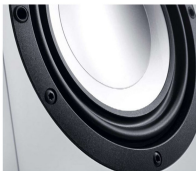
Die Tieftormembran aus Aluminium wird von einer sehr großen Staubschutzkalotte stabilisiert, die geschwungene Wave-Sicke sorgt für lineares Verhalten unabhängig von der Auslenkung.
