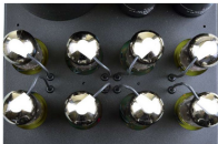
Nur für Servicepersonal: Kleine Bohrungen im Chassis schaffen Zugang zu den Pots, mit denen auf geringstmögliche Gleichspannung im Ausgang abgeglichen wird. Ansonsten bleibt die Haube zu.
