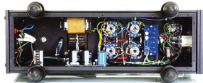
Der Signalverlauf ist komplett frei verdrahtet. Im Netzteil kommt für den Endröhrentrakt eine Siebspule zum Einsatz, während sich Eingangs- und Treiberstufe auf ihre eigene Trafowicklung nebst Gleichrichter und RC-Siebstufen verlassen können. Die schwere Endstufe steht auf vier dämpfenden Gummifüßen.
