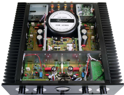
Die üppig ausgelegte Elektronik des Vincent füllt den normbreiten Amp praktisch aus. Rechts hinten der eingebaute DAC mit optischem und koaxialen Eingang, in der Mitte links und rechts die beiden Endstufen-Sektionen mit den an die Kühlrippen isoliert, aber wärmeleitend angeflanschten, bipolaren Endtransistoren. Die Eingangsrohre ECC83 (vorne in der Mitte) sitzt in einem rot beleuchteten „Zimmerchen“.
