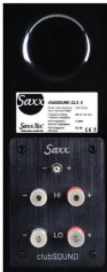
Links: Ungewöhnlich in der Preisklasse der club- und coolSOUND-Boxen ist der Air Motion Transformer, der für den Frequenzbereich ab 3000 Hz zuständig ist. Mittel- und Tieftöner besorgt bei der clubSOUND eine glasfaserverstärkte Kunststoffmembran. Rechts: Die kompakte clubSOUND verfügt über ein Bi-Wiring-Terminal.
