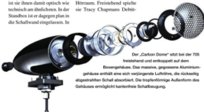
Der „Carbon Dome“ sitzt bei der 705 freistehend und entkoppelt auf dem Boxengehäuse. Das massive, gegossene Aluminiumgehäuse enthält eine sich verjüngende Luftröhre, die ruckseitig abgestrahlten Schall absorbiert. Die tropfenförmige Außenform des Gehäuses ermöglicht kantenfreie Schallbeugung.
