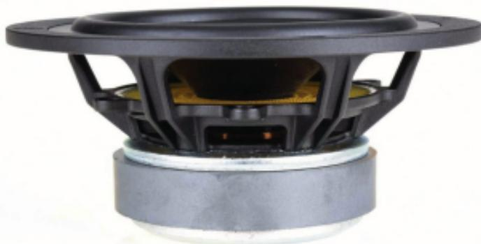
Der 13er-Tiefmitteltöner lässt die Membran aus verbackenem Carbonfasergeflecht erkennen. Hinter der Zentrierspinne bleibt ausreichend Platz für Luftauflöse, was Kompressionseffekte der groß dimensionierten Überhangspule verringert. Auch die große Sicke steht höheren Auslenkungen nicht im Wege.
