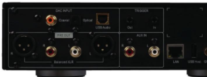
Übersichtlich: Oben links befinden sich die Digitaleingänge, daneben zwei Klinkebuchsen für ein- und ausgehende Triggersignale. Darunter liegen die Analoganschlüsse, links die symmetrischen und unsymmetrischen Ausgänge, rechts ein AUX-Eingang. Die USB-Host-Buchse und der Netzwerkanschluss deuten auf Streaming-Fähigkeiten hin, WLAN, Bluetooth und AirPlay beherrscht der Sonica DAC auch.
