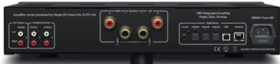
Der analoge Cinch-Ausgang ganz links auf dem Anschlussfeld liefert einen geregelten Line-Pegel und eignet sich deshalb zur Ansteuerung einer zusätzlichen Endstufe (Stichwort: Bi-Amping) oder eines Subwoofers. Streaming- und DAC-Eingänge sind rechts zu sehen, wobei die USB-B-Schnittstelle zum Rechner hier synchron ist; akzeptiert werden PCM-Datenformate bis 24 Bit/192 kHz.
