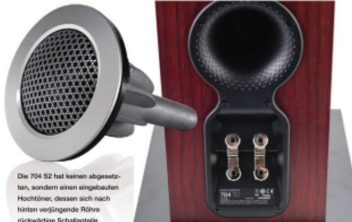
Die 704 S2 hat keinen abgesetzten, sondern einen eingebauten Hochtöner, dessen sich nach hinten vorjüngende Röhre rückwärtig Schalanteile resonanzfrei vermischt. Die Membran und damit die hohe Aufbruchfrequenz von 47 kHz sind bei allen Modellen der Serie identisch.
