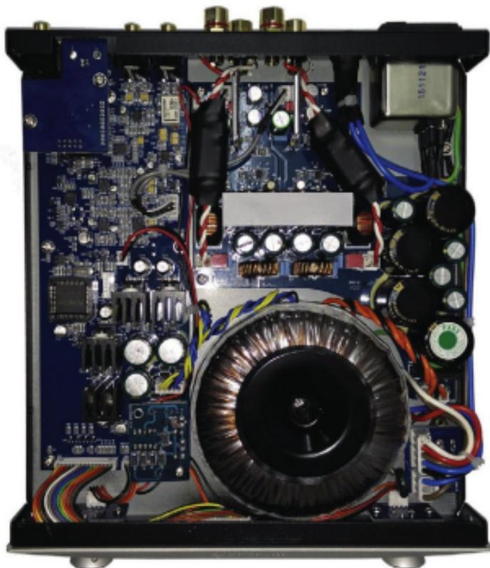
Ein dicker Ringkerntransformator versorgt den Class-D-Amp mit Energie, kurze Signalwege sorgen dafür, dass die Musik möglichst sauber an den Lautsprecherklemmen anliegt. Die Lautstärkeregelung arbeitet analog/digital in 99 0,5-dB-Stufen.
