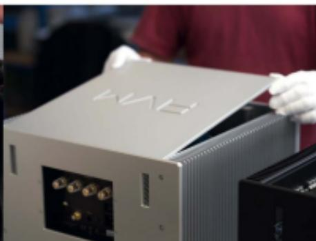
Die Komponenten der Ovation-Serie mit ihren schweren, großen Gehäusen sind auch in der Produktion anspruchsvoll zu bauen und werden deshalb alle komplett in Handarbeit in Deutschland montiert. Da die seitlichen Kühlkörper (im Bild der Mono-Endstufe MA 8.2) zugunsten besserer Wärmeableitung Teil des Gehäuses sind, gelten hier geringste Toleranzen und äußerste Präzision als absolutes Muss.
