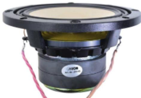
Der mächtige Doppelferritmagnet und die weit ausladende Zentralspinne sorgen für Hub, die Schwingspule selbst ist vom Durchmesser her eher klein. Die trichterförmige Keramikmembran wird durch eine ebensolche Staubchutzkappe vorne stabilisiert.
