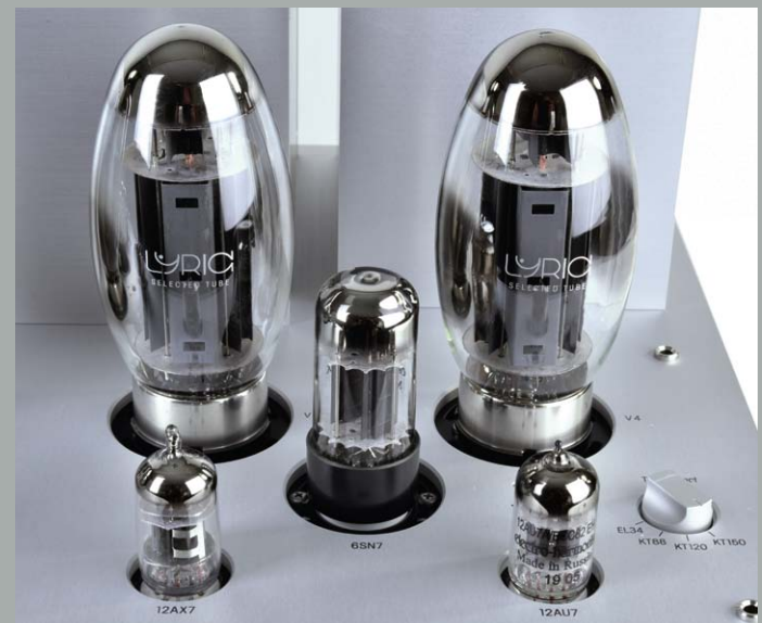
In der Treiberstufe arbeitet die kräftige Doppeltriode 6SN7, als Phasendreher kommt pro Kanal eine 12AU7 zum Einsatz.
