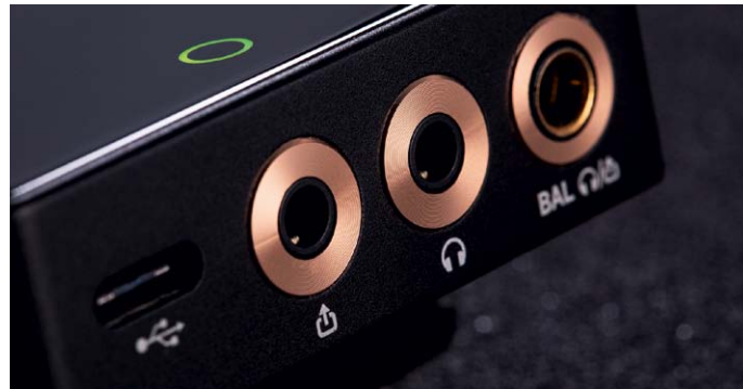
Das Triple gewonnen: Per 3,5er-Klinke können wir hinein, in der Mitte heraus und ganz rechts sogar ein Balanced-Signal abzapfen.
