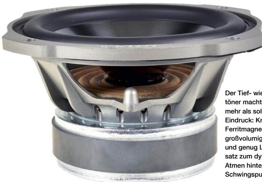
Der Tief- wie Mittel-töner macht einen mehr als soliden Eindruck: Kräftiger Ferritmagnet, großvolumige Sicke und genug Luftdurchsatz zum dynamischen Atmen hinter der Schwingspule.
