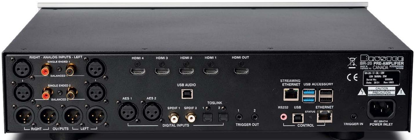
Der BR-20 bietet analoge und digitale Anschlüsse auch symmetrisch, nur ein Cinch-Analogausgang fehlt. Für Video gibt es vier HDMI-Eingänge und einen HDMI-Ausgang ohne Audiosignale. Vielfältig sind die Synchronisations- und Steuerungsmöglichkeiten für Heimautomation.
