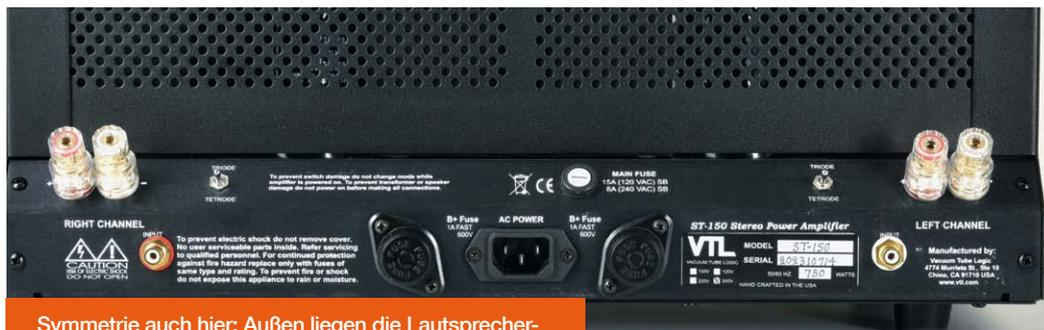
Symmetrie auch hier: Außen liegen die Lautsprecherklemmen, darunter die Zugänge per Cinch. In der Mitte dominiert die Stromzufuhr mit zwei Sicherungen.
