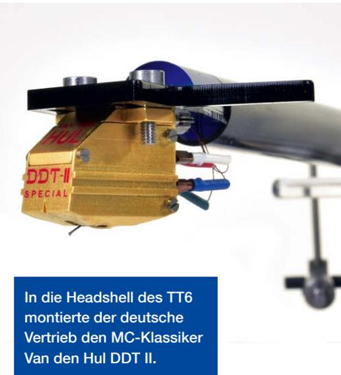
In die Headshell des TT6 montierte der deutsche Vertrieb den MC-Klassiker Van den Hul DDT II.
