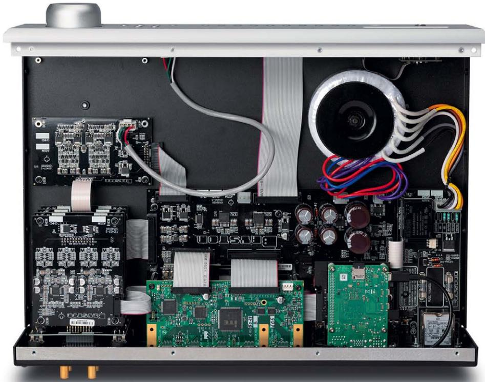
Zur Profitechnik des BR-20 gehört das lineare Netzteil mit Ringkerntrafo und die separate Versorgung digitaler und analoger Bereiche. In der Mitte sitzt die HDMI-Platine, links daneben das Phono-Board.
