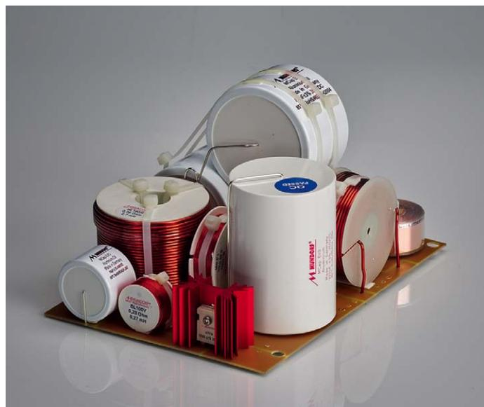
Für eine 3-Wege-Weiche erstaunlich spärlich bestückt, dafür kommen nur beste Bauteile zum Einsatz. Vorne (auf dem roten Kühlkörper) die neuen Mundorf Super Resistors.
