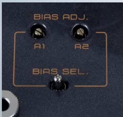
Einfache Ruhestromeinstellung: Hier sollte niemand überfordert sein, das Rundinstrument auf der Frontplatte zeigt, was Sache ist. Via Wahlschalter „Bias Select“ wird die Messung der jeweiligen Endröhre aktiviert.
