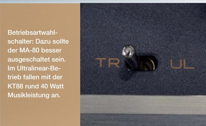
Betriebsartwahlschalter: Dazu sollte der MA-80 besser ausgeschaltet sein. Im Ultralinear-Betrieb fallen mit der KT88 rund 40 Watt Musikleistung an.
