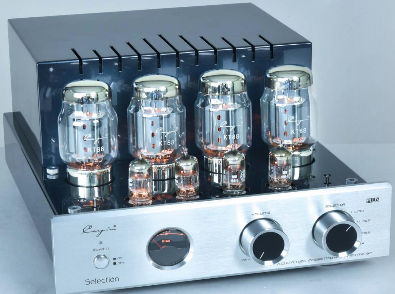
Anodenspannungsversorgung, über ein ordentliches Lautstärke-Poti und über klanglich vielversprechende Folien-Koppelkondensatoren. Alle Trafos und die Netzteilkondensatoren stecken hier unter einer festen Haube, für das Röhrenensemble gibt es ebenfalls eine Abdeckung.
