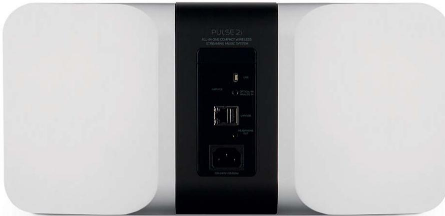
Energie muss sein: unten der zentrale Kaltgeräte-Anschluss, darüber ein Ethernet-Port und ein USB-Zugang. Signale nimmt der 2i aber auch per Toslink und WLAN entgegen.
