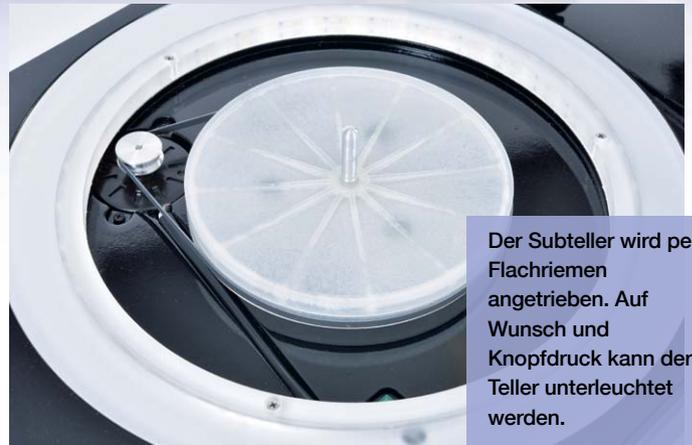
Der Subteller wird per Flachriemen angetrieben. Auf Wunsch und Knopfdruck kann der Teller unterleuchtet werden.
