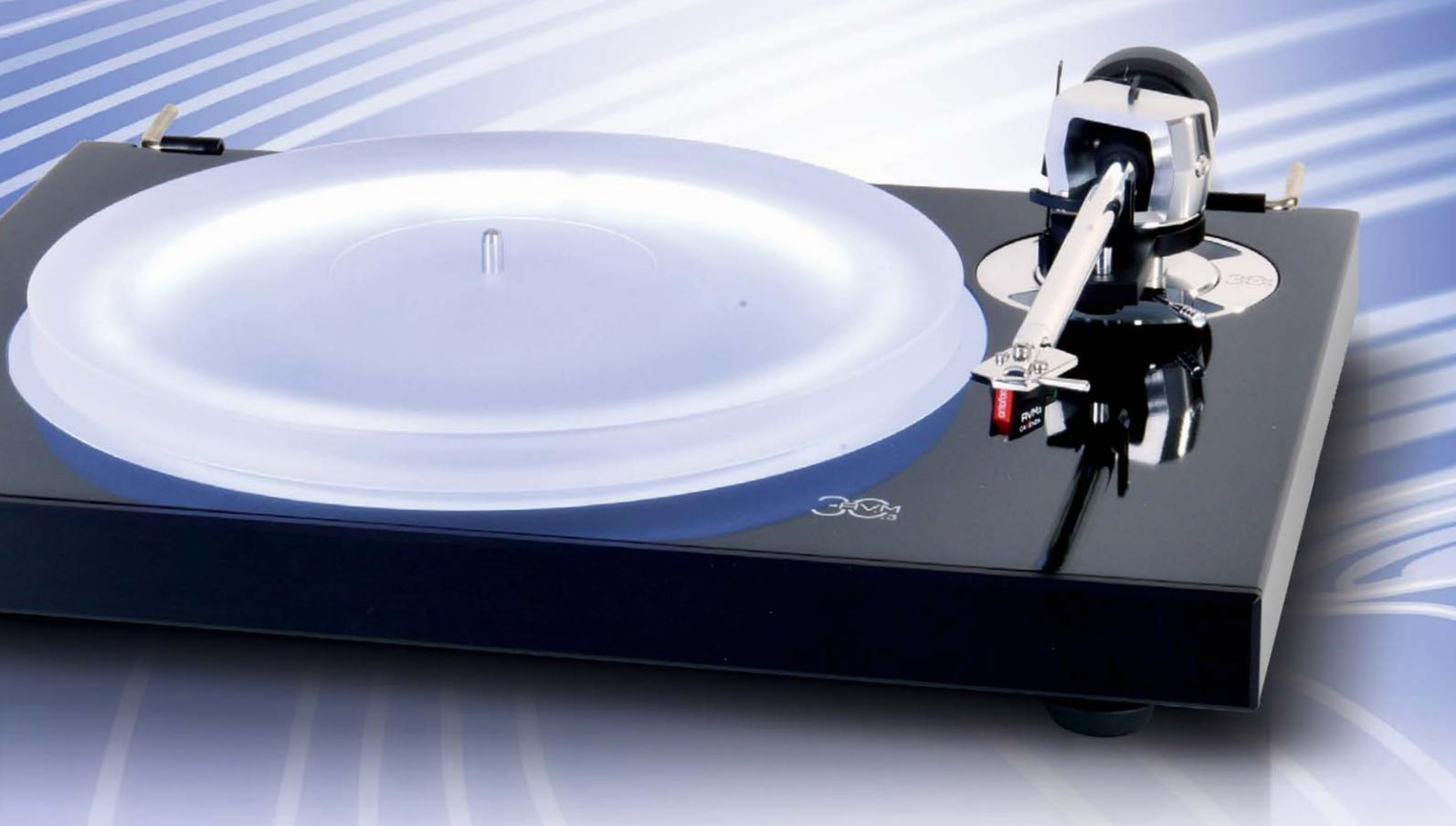
dard und in Kunststoff zugekauft. Die Federfüße wurden reduziert – aber eben auch maßgeschneidert auf das nunmehr geringere Gesamtgewicht. Ebenso wurde die Zarge vereinfacht. An der Front liegt eine Platte aus Aluminium, dahinter ein Aufbau aus hochdichter Faserplatte, mit Metall-Splittern verstärkt und beschwert.
