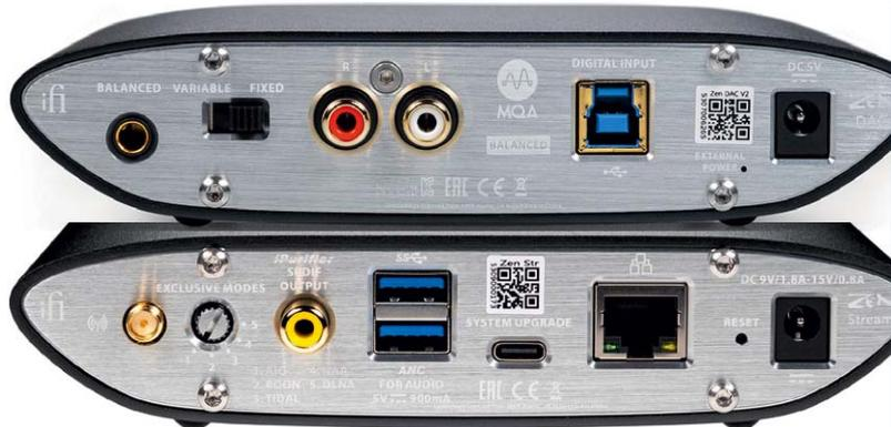
Der iFi-DAC (oben) enthält symmetrische und asymmetrische Ausgänge, den Digital-Eingang aber nur per USB. Der Streamer bietet LAN/WLAN sowie wählbare Grundkonfigurationen.
