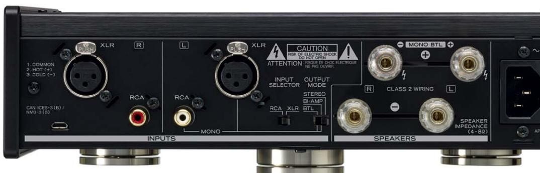
Mit kleinen Schaltern wählt man den Eingang (Cinch oder XLR) aus und die Betriebsart (normal, gebrückt, Bi-Amping). Das Gehäuse ist sehr hochwertig, die Anschlüsse und Klemmen auch.
