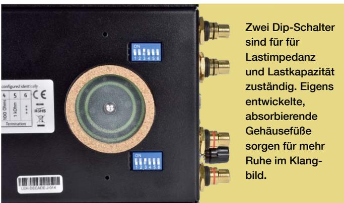
Zwei Dip-Schalter sind für Lastimpedanz und Lastkapazität zuständig. Eigens entwickelte, absorbierende Gehäusefüße sorgen für mehr Ruhe im Klangbild.
