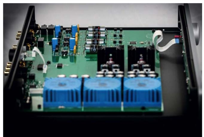
Schaltung als Wertanlage: Atoll ist Fan von MosFET-Transistoren plus Stufen in reinem Class-A. Das hört man, das kann man messen.
