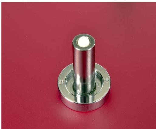
Das hochwertige Lager setzt auf einen kurzen, dicken Dorn und kombiniert eine Keramik-Lagerkugel mit einem Teflon-Lagerboden bzw. -Lagerdach, weil es sich um ein invertiertes Lager handelt.
