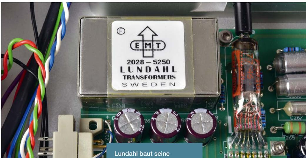
Lundahl baut seine MC-Übertrager in verschiedenen Übersetzungsfaktoren, „Medium“-Modelle eignen sich für Tonabnehmer mit einer Ausgangsimpedanz von etwa zehn bis 40 Ohm und damit für die überwiegende Mehrheit der MC-Abtaster.
