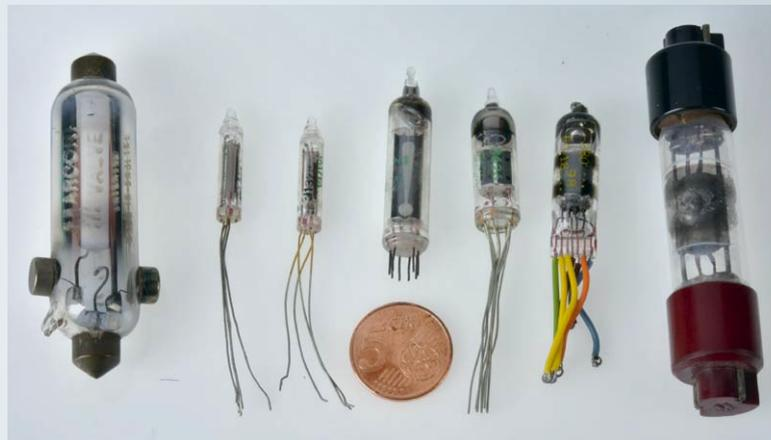
Beispiele für Miniaturröhren: Ganz links die Marconi-Osram D.E.V., dazwischen diverse 50er- und 60er-Jahre-Exemplare in verschiedenen Sockelungsvarianten, ganz rechts die Myers RAC3, eine kanadische Batterieröhre.
