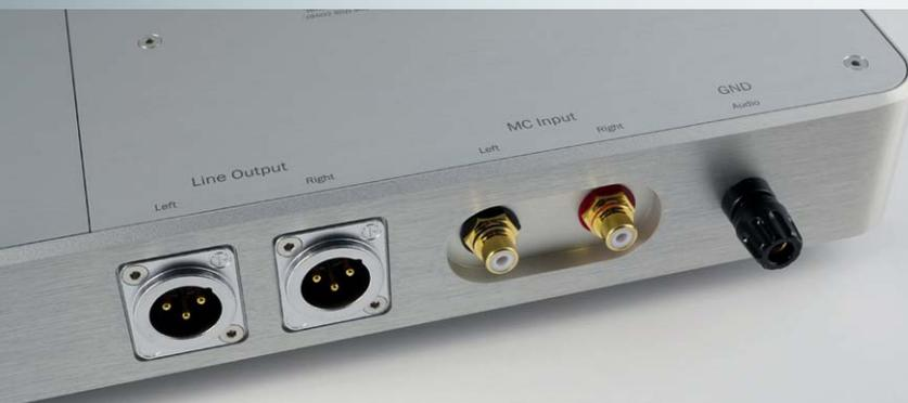
Unsymmetrischer Eingang zum MC-Übertrager, via Ausgangsübertrager symmetrierter XLR-Ausgang. Einen unsymmetrischen Ausgang gibt es nicht. Die gemessene Ausgangsimpedanz beträgt 340 Ohm.
