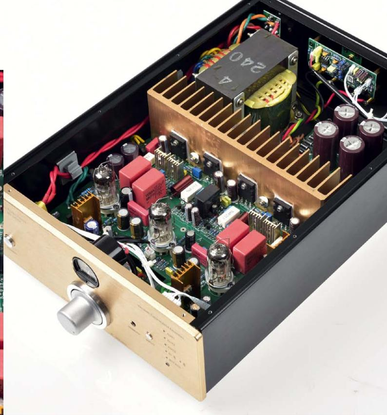
Den hinteren Teil füllt das Netzteil, vorne sitzt die Schaltung. In der Eingangsstufe arbeiten drei Doppeltrioden vom Typ 6N11. Die mittlere besorgt die Eingangsverstärkung, die beiden anderen kanalgetrennt die Vorverstärkung. Den Rest besorgen Toshiba-Transistoren auf dem Kühlkörper.
