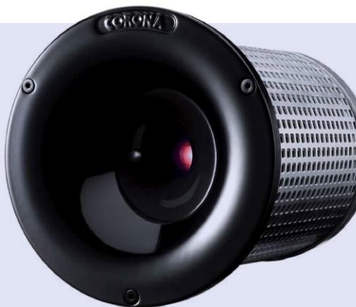
Im Corona-Hochtöner brennt ein durch Hochfrequenzenergie erzeugtes Plasma, das durch das Audio-Signal in der Ausdehnung moduliert werden kann.
