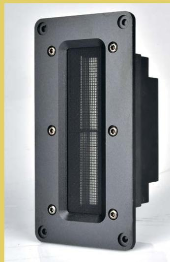
Die Membran des Hochtöners besteht aus einem nur oben und unten aufgehängten Streifen 8 Millimeter breitem Aluminium, der Magnet hinten ist sehr kräftig.
