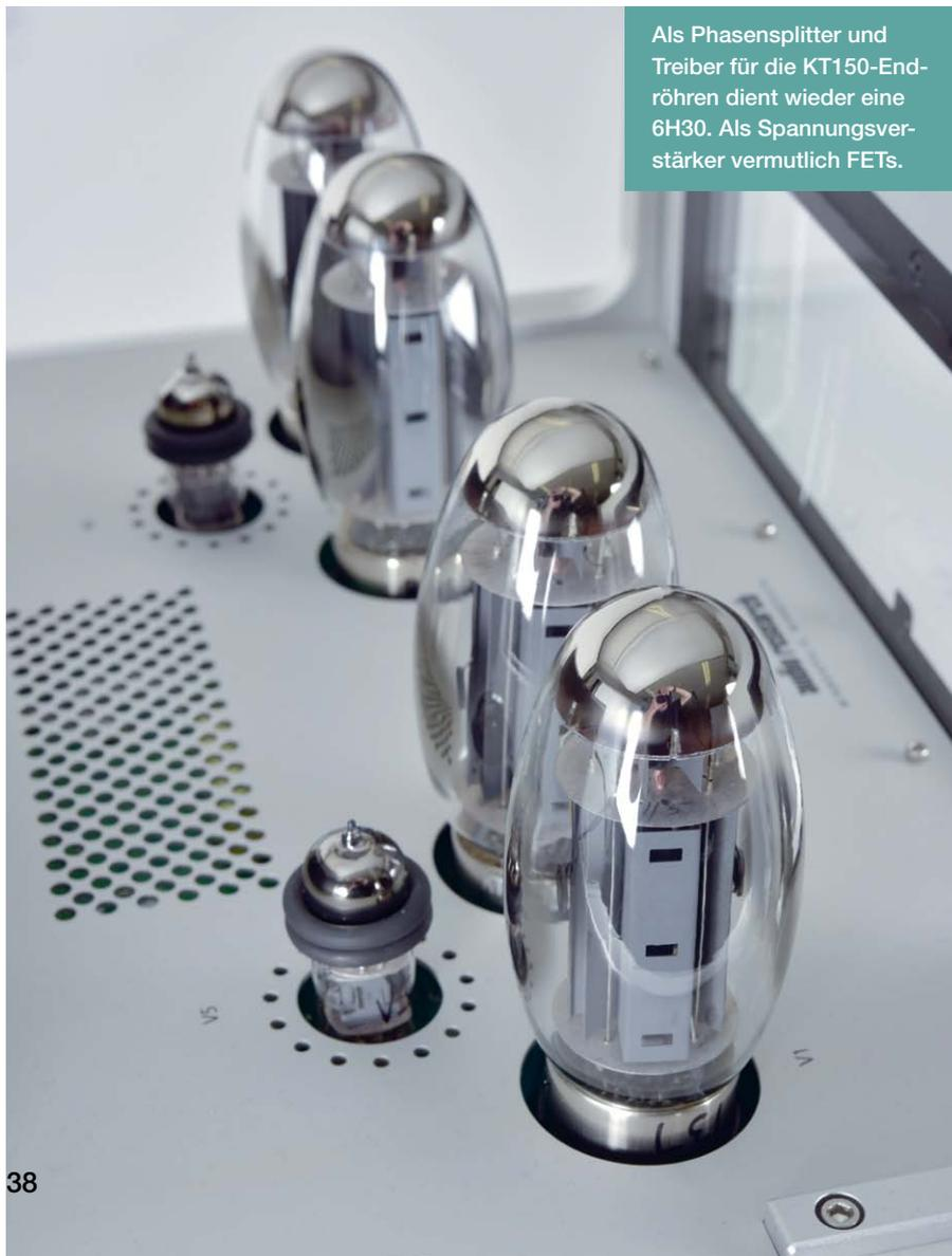
Als Phasensplitter und Treiber für die KT150-Endröhren dient wieder eine 6H30. Als Spannungsverstärker vermutlich FETs.
