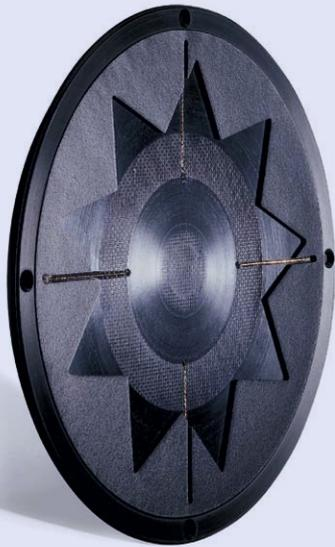
Die elektrodynamisch angetriebene, flache Membran des Mangers ist in der Mitte fixiert. Der zackenförmige Rand dämpft Kantenreflexionen.
