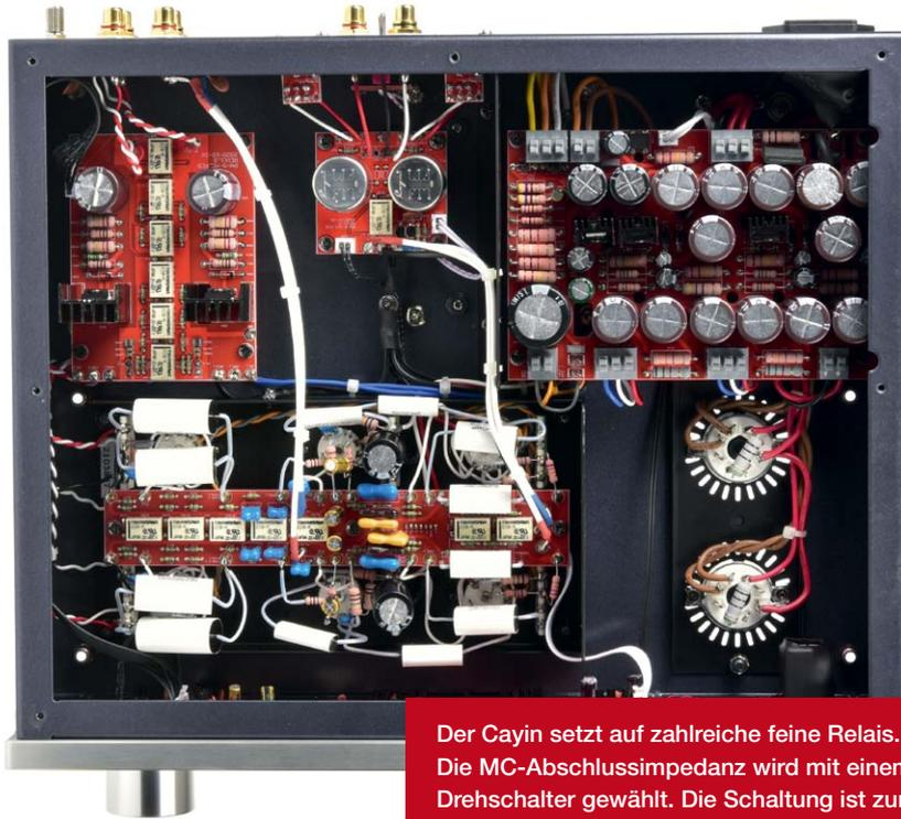
Der Cayin setzt auf zahlreiche feine Relais. Die MC-Abschlussimpedanz wird mit einem Drehschalter gewählt. Die Schaltung ist zum Teil frei verdrahtet und hochwertig bestückt.
