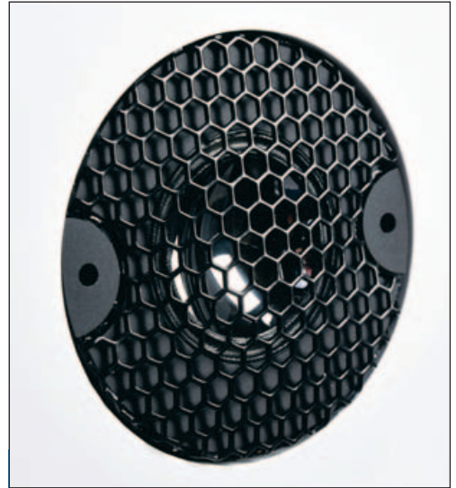
Künstlicher Diamant ermöglicht es, die erste Membranresonanz eines Hochtöners sehr weit über den Hörbereich zu schieben.
