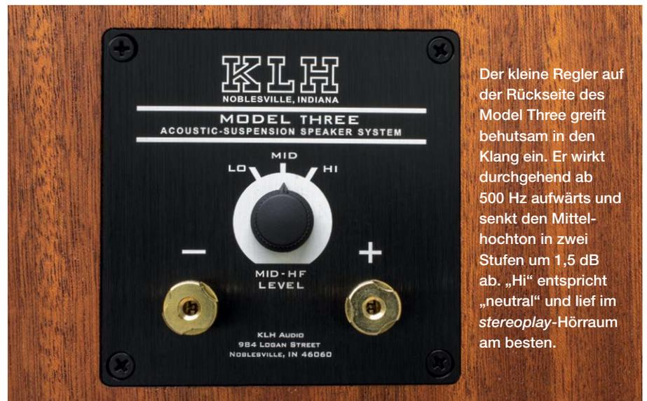
Der kleine Regler auf der Rückseite des Model Three greift behutsam in den Klang ein. Er wirkt durchgehend ab 500 Hz aufwärts und senkt den Mittelhochton in zwei Stufen um 1,5 dB ab. „Hi“ entspricht „neutral“ und lief im *stereoplay*-Hörraum am besten.
