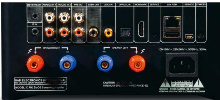
Neben analogen und digitalen Eingängen bietet der C700 auch einen Vorstufenausgang sowie HDMI-In für TV-Ton per Rückkanal.
