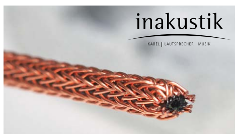
Jeder Leiter besteht selbst aus 24 hochreinen, lackisolierten Kupferdrähten, die auf einen PE-Kern geflochten sind.
