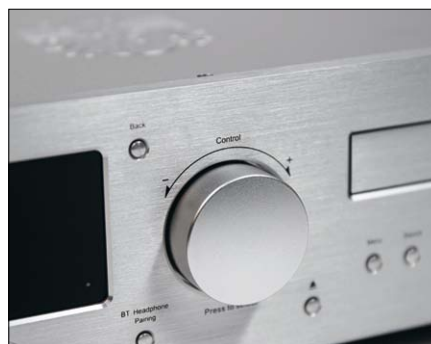
In Verbindung mit dem Display dient der Lautstärkekнопf auch der Menü-Eingabe.
